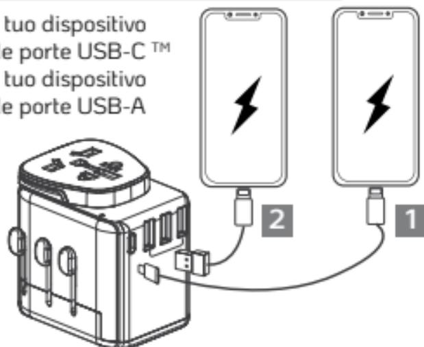
Collegare i dispositivi alle porte USB dell'adattatore con un cavo di ricarica / sincronizzazione
